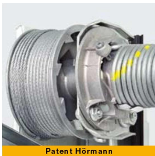
Obr. 13 Technika torzní pružiny s integrovanou pojistkou proti zlomení pružiny [10]
